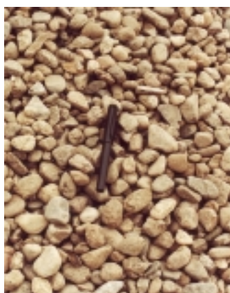
A la derecha, imagen del canto rodado de cubierta y su tamaño referenciado con un bolígrafo.
